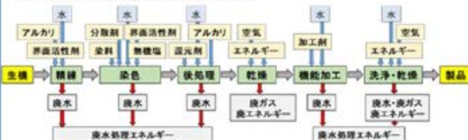
（図2）革新技术：無水型超臨界染色加工
