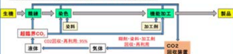
（図2）革新技术：無水型超臨界染色加工
