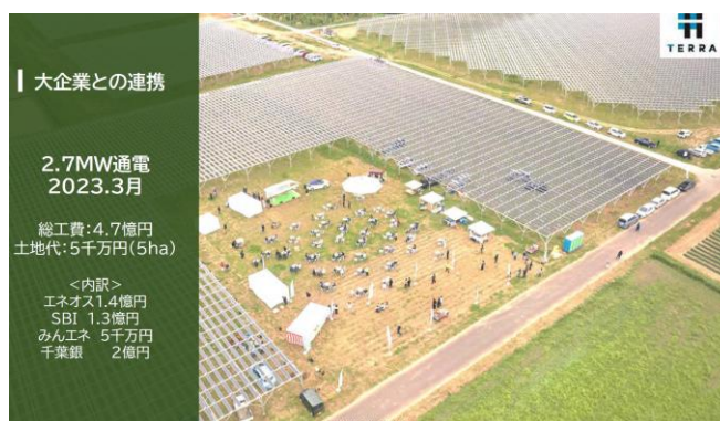
図 2 大企業との連携によるソーラーシェアリングの例： 匣瑛おひさま発電所 出所：株式会社 TERRA
