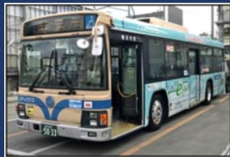
大型路線バス (低床フロア型) バッテリー容量160kWh 急速充電100kW対応
