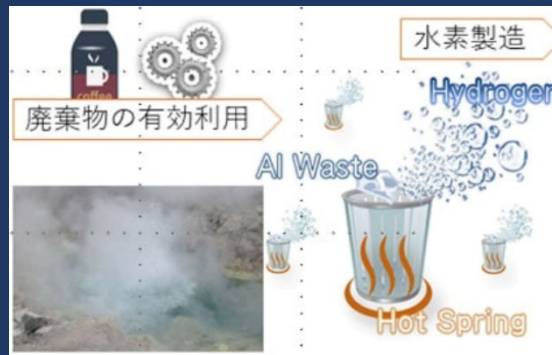
強酸性温泉と廃アルミニウムを利用した 水素製造 (東北大学)
